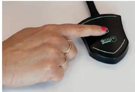
Eine Berührung der Sensorfläche reicht und der Transmitter geht auf Sendung.
